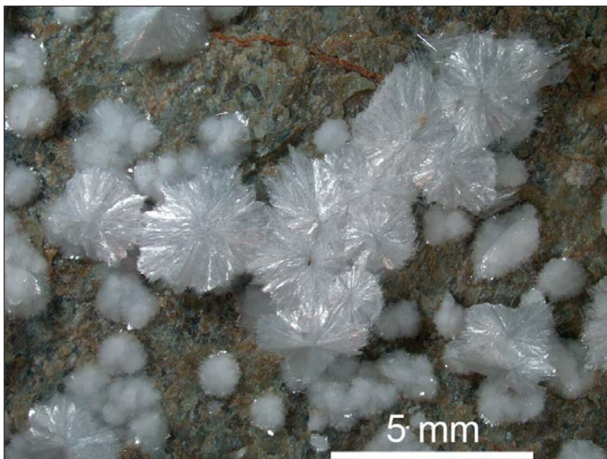
Obr. 4. Paprscitá stavba polokulovitých agregátů hydromagnezitu typu I, Hrubšice. Foto M. Ivanov. Fig. 4. Radial structure of the hydromagnesite aggregates of the type I, Hrubšice. Photo M. Ivanov.
